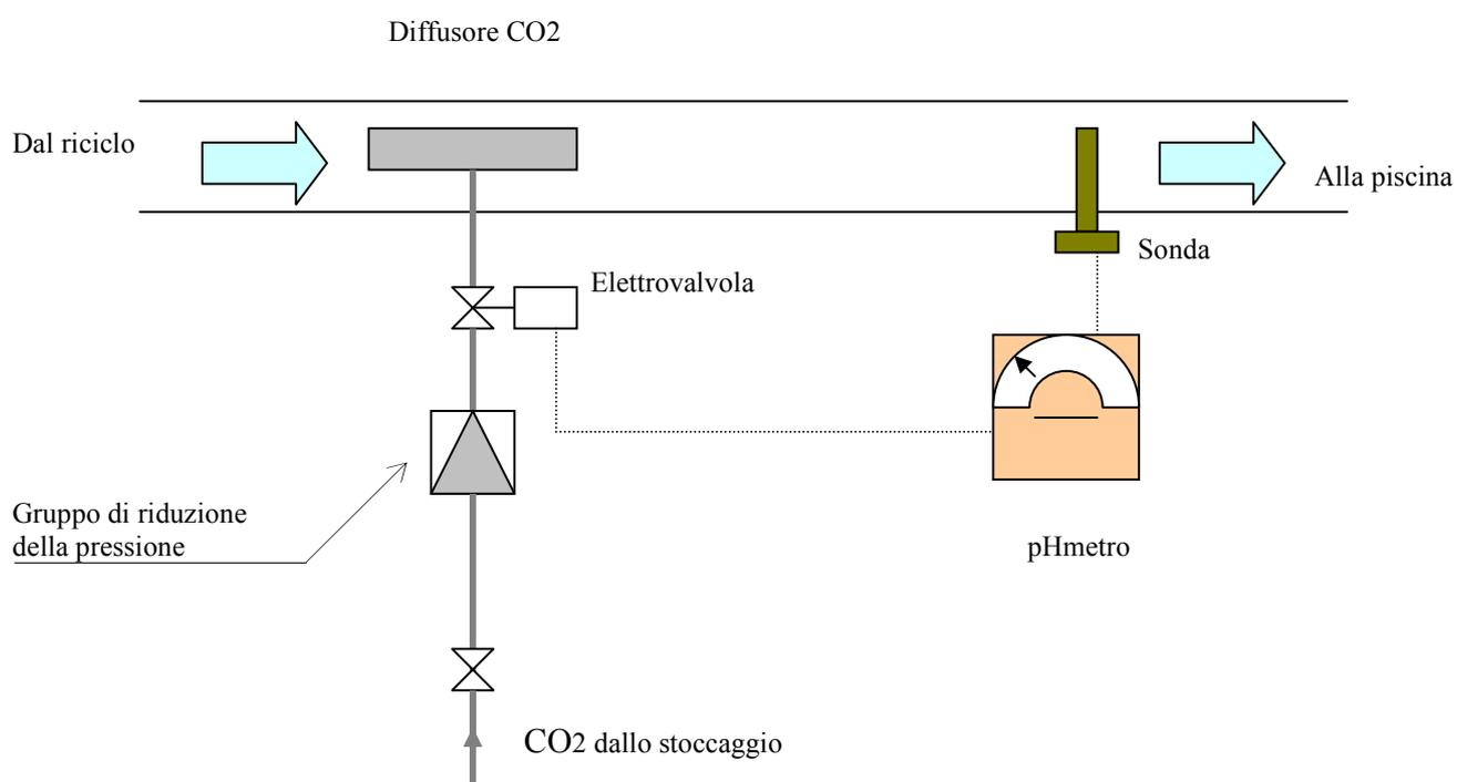
La CO<sub>2</sub> gassosa prelevata dallo stoccaggio (bombole o serbatoio), viene convogliata, dopo aver subito una riduzione della pressione, ad un erogatore/diffusore che permette la distribuzione della CO<sub>2</sub> nel fluido da trattare.
